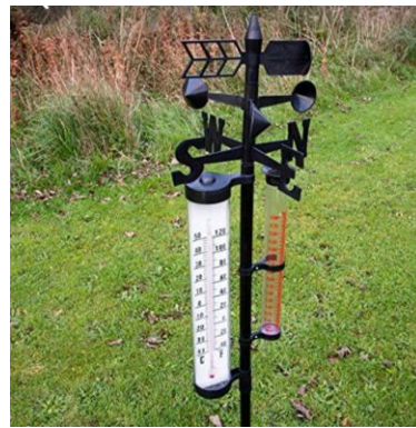
Εικόνα 12: Θερμόμετρο, Ανεμόμετρο, Βροχόμετρο
